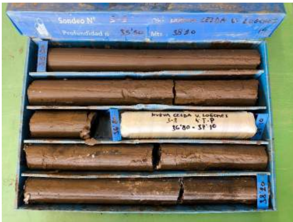
Sondeo S-2, caja 14, de 35,90 m a 38,20 m de profundidad.
