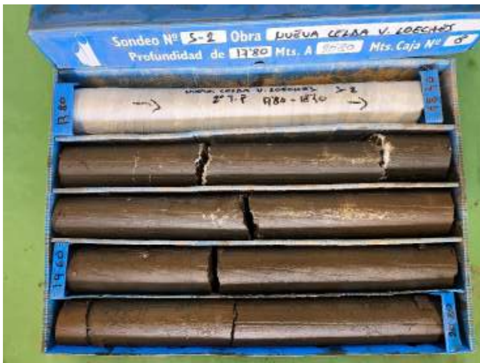
Sondeo S-2, caja 8, de 17,80 m a 20,80 m de profundidad.
