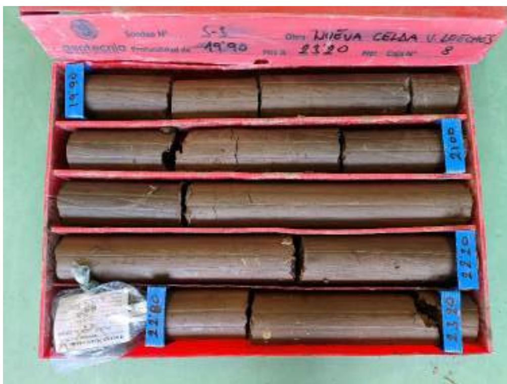
Sondeo S-3, caja 8, de 19,90 m a 23,20 m de profundidad.
