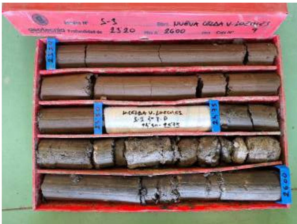
Sondeo S-3, caja 9, de 23,20 m a 26,00 m de profundidad.
