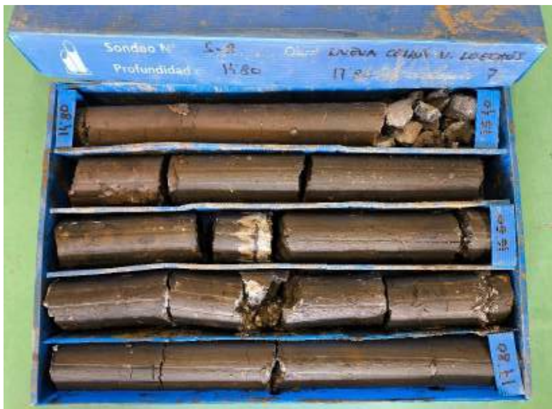
Sondeo S-2, caja 7, de 14,80 m a 17,80 m de profundidad.
