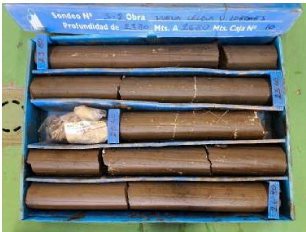
Sondeo S-2, caja 10, de 23,80 m a 26,80 m de profundidad.
