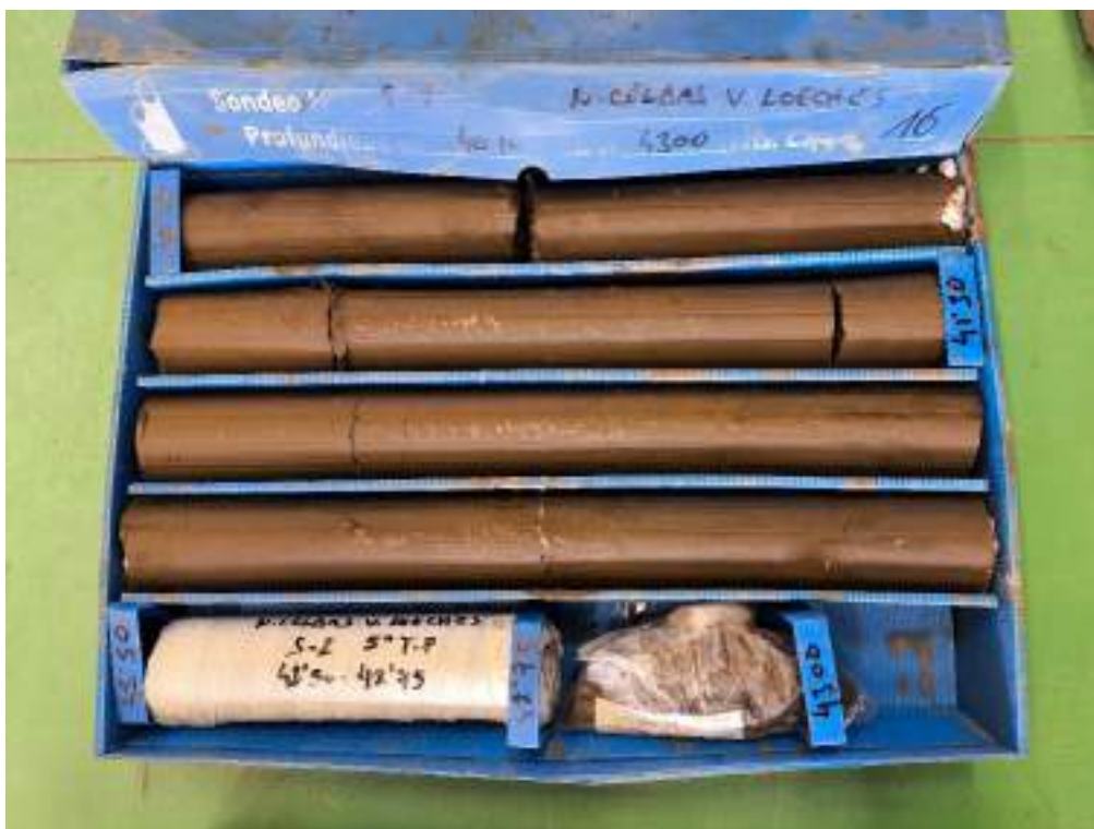
Sondeo S-2, caja 16, de 40,10 m a 43,00 m de profundidad.
