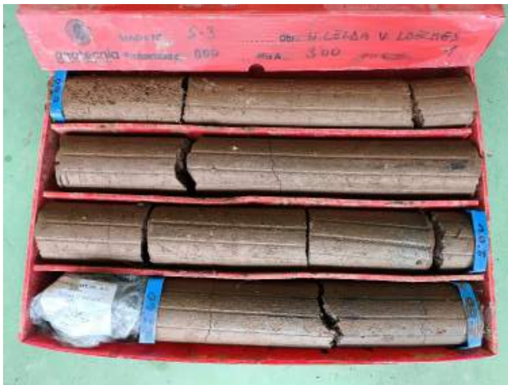
Sondeo S-3, caja 1, de 0,00 m a 3,00 m de profundidad.
