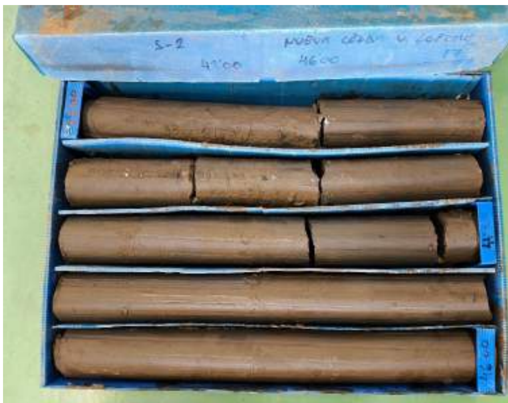
Sondeo S-2, caja 17, de 43,00 m a 46,00 m de profundidad.
