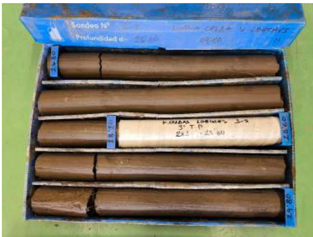
Sondeo S-2, caja 11, de 26,80 m a 29,80 m de profundidad.
