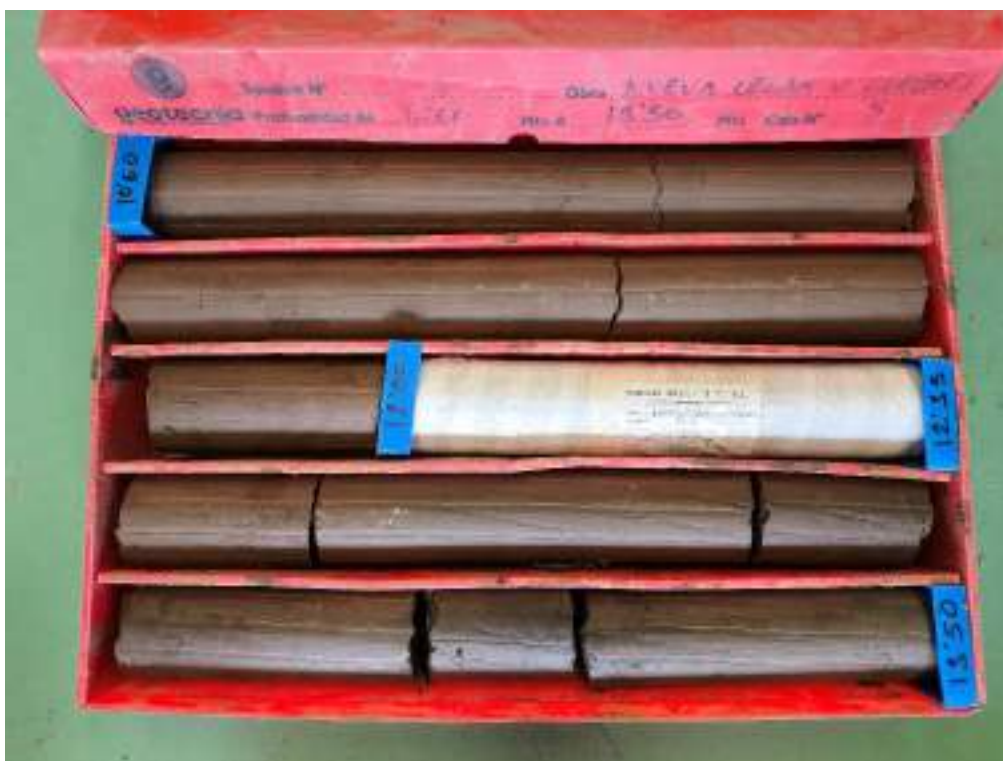
Sondeo S-3, caja 5, de 10,60 m a 13,50 m de profundidad.
