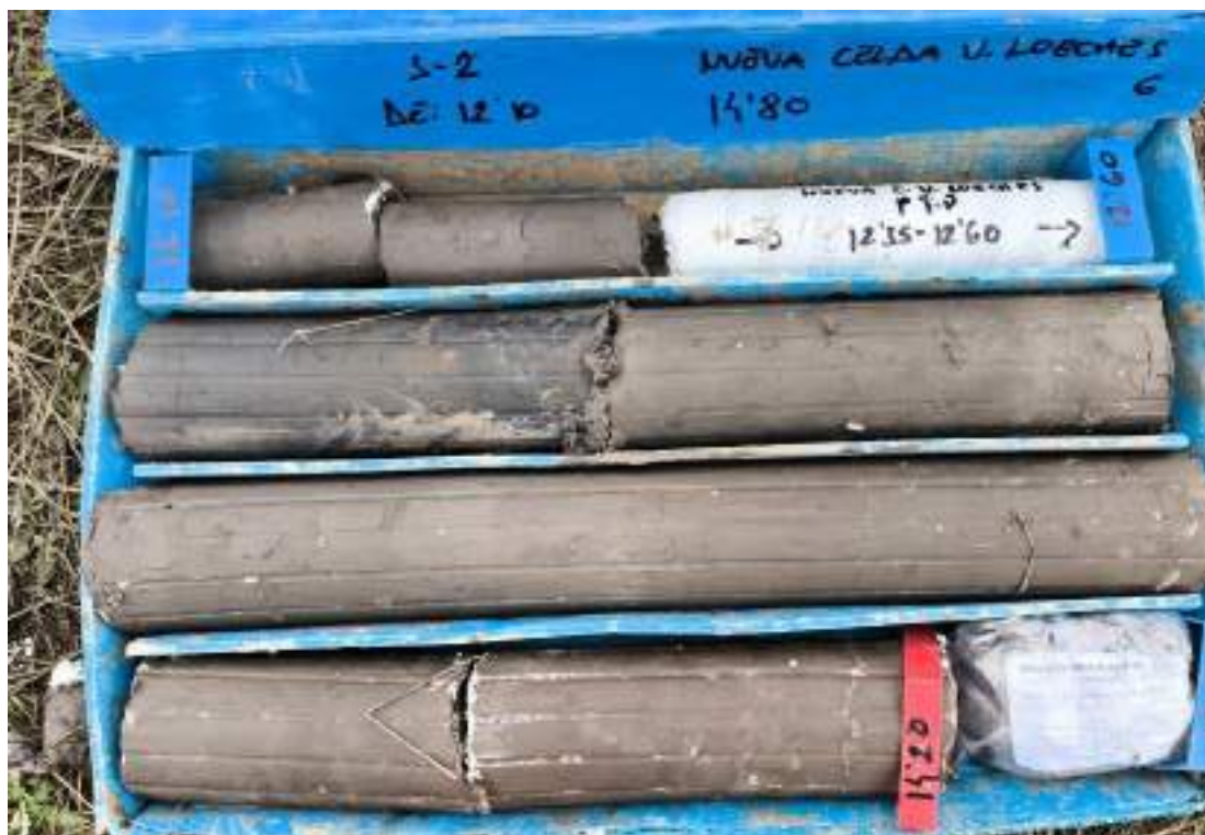
Sondeo S-2, caja 6, de 12,10 m a 14,80 m de profundidad.
