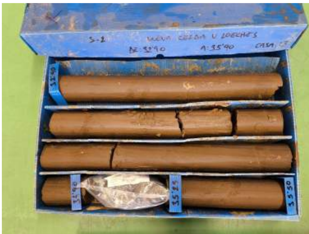
Sondeo S-2, caja 13, de 32,90 m a 35,90 m de profundidad.
