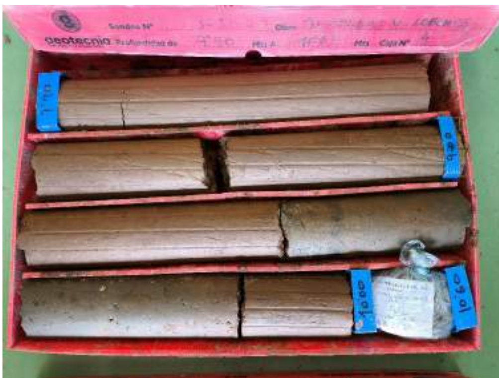
Sondeo S-3, caja 4, de 7,90 m a 10,60 m de profundidad.
