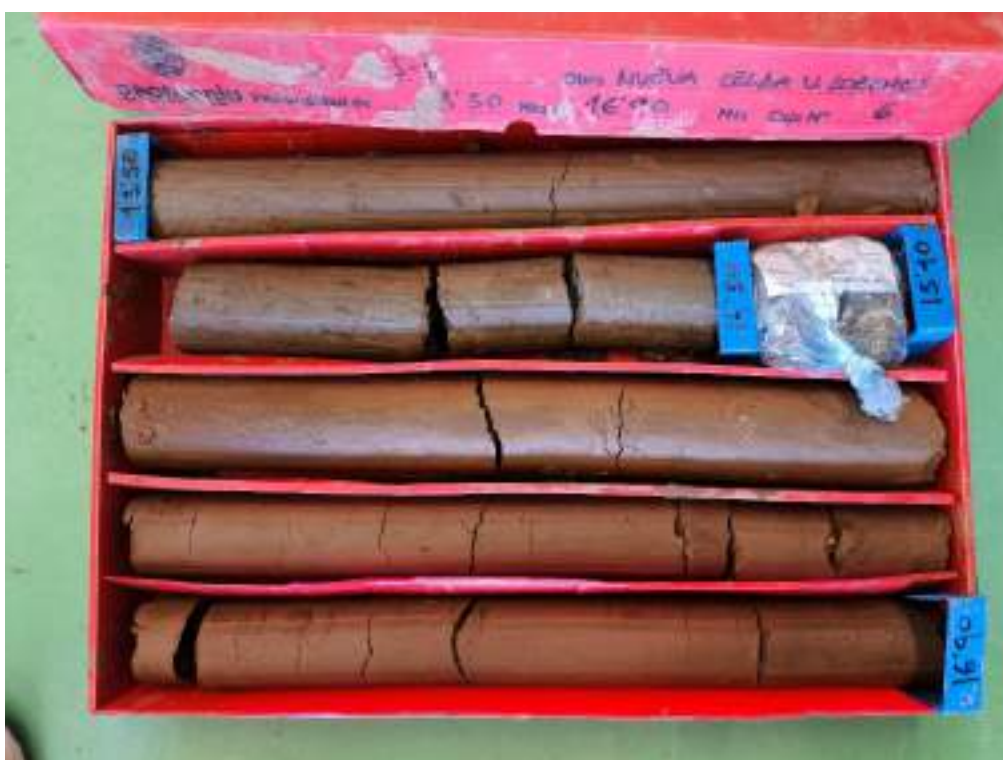
Sondeo S-3, caja 6, de 13,50 m a 16,90 m de profundidad.
