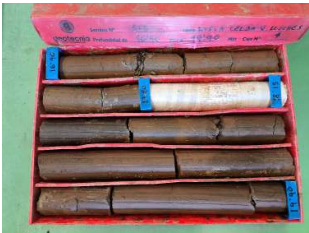
Sondeo S-3, caja 7, de 16,90 m a 19,90 m de profundidad.
