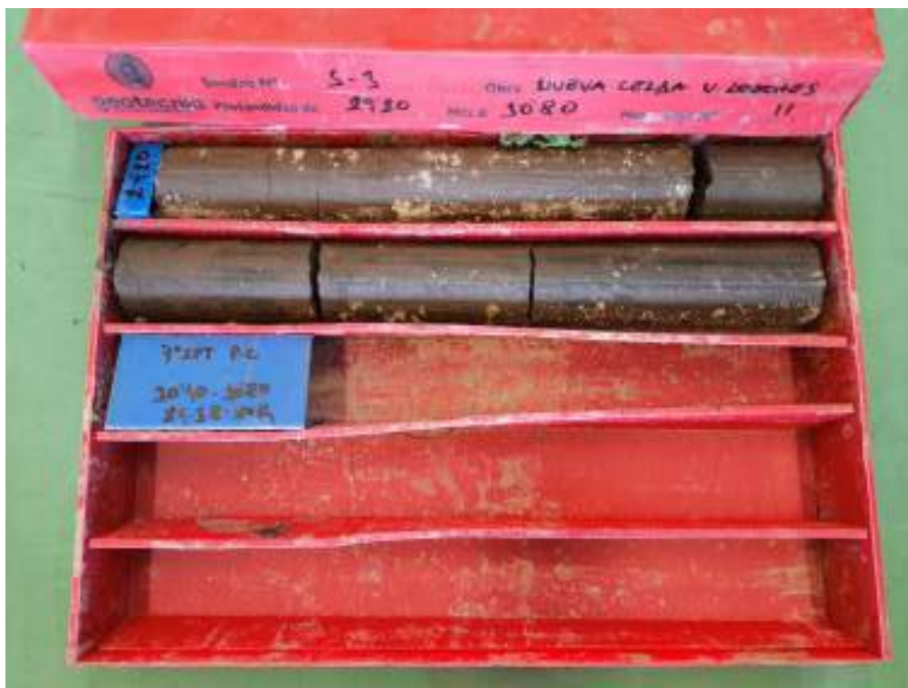
Sondeo S-3, caja 11, de 29,20 m a 30,80 m de profundidad.
